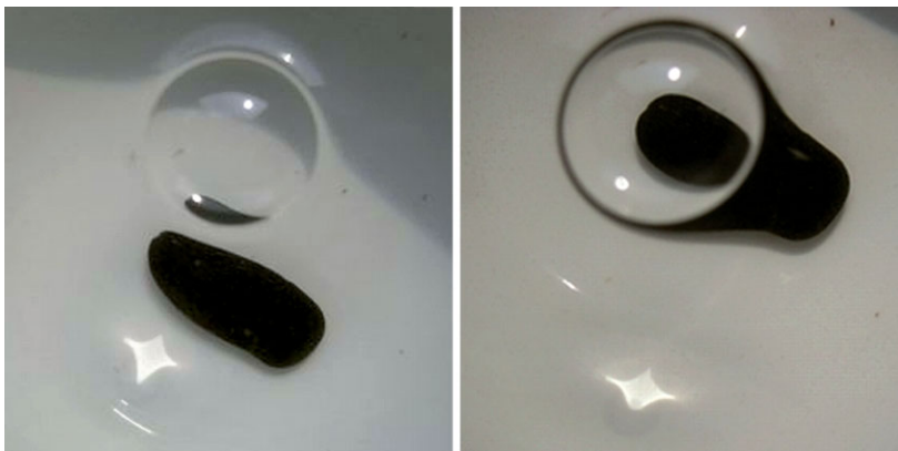
Abb. 1 Links: Eine Schaumblase auf der Wasseroberfläche erzeugt am Boden eine sternförmige Kaustik. Rechts: Die Blase wirkt als Zerstreuungslinse und ruft ein verkleinertes Bild eines am Boden liegenden Steins hervor.
